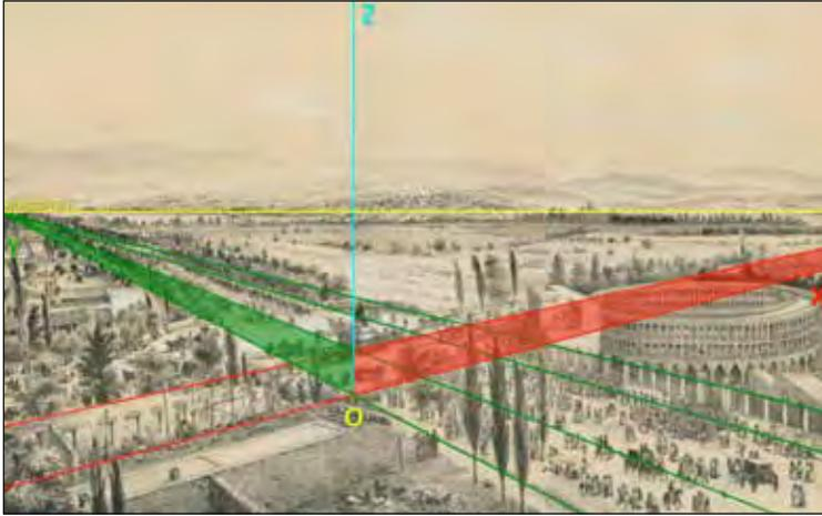
Fig. 12. Litografía con dos puntos de fuga que se intersecan en el punto de origen.
